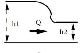
$\Delta h = \frac{(h_1 - h_2)^3}{4h_1h_2} - \frac{(h_1 - h_2)^3}{4h_1h$
